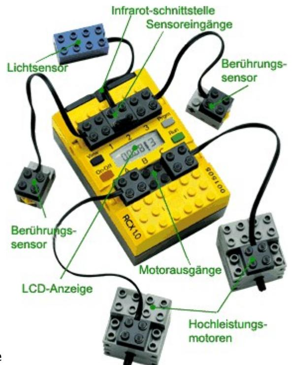
Die Steuerung des Roboters erfolgt über die Infrarotschnittstelle. Es ist möglich dem Roboter via Computer einzelne Befehle zu geben oder ganze Programme zu übermitteln. So können sich MindStorms mithilfe intelligenter Programme selbständig in der Umwelt bewegen und auf Inputs der entsprechenden Sensoren verhältnismässig reagieren. Die Kommunikation mit anderen RCX Mikrocomputern ist ebenfalls möglich.
